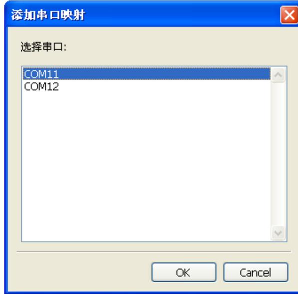
选择 COM11 后单击 OK 即可完成映射工作。用同样的方式将 COM12 映射给二号机。
