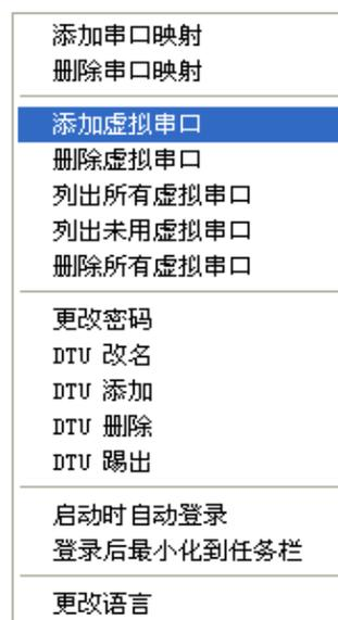
选择 COM11 单击 OK。然后连续点击**两遍**【下一步】和【完成】即可完成 COM11 的添加。同样的方式再将 COM12 添加进来。如添加成功，右键选择列出所有的虚拟串口则会在系统信息标签显示如下字样：
