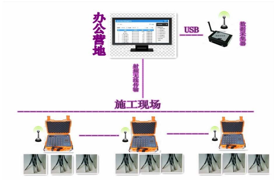
无线射频传输示意图（实际传输距离 1500 米左右）
